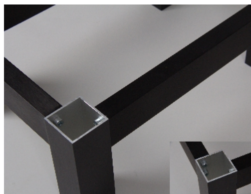
Соединение квадратных труб (40x40, 45x45) винтами с прямоугольной трубой (40x20) через приливы
