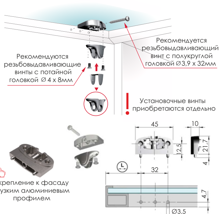
Установка крепления к фасаду с узким алюминиевым профилем
