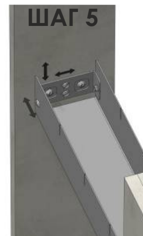
Схема сверлений фасада для крепления карго 300
